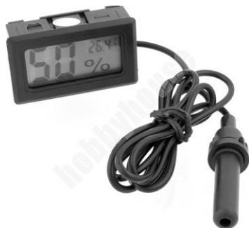
Rysunek 3. Wygląd rzeczywisty czujnika B2
